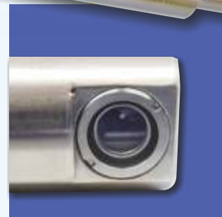
TV-Endoskop mit Wasser- und Schweißfiltereinschub, Objektiv-Blickrichtung 90° mit wechselbarem Saphir-Schutzglas und Freiblasvorrichtung
